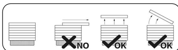
Si nécessaire, en fonction de la taille et du poids de chaque panneau, il est conseillé de prévoir des dispositifs de levage mécaniques appropriés, tels que des **élévateurs à ventouse** ou des **pincés/mâchoires** spéciales.
