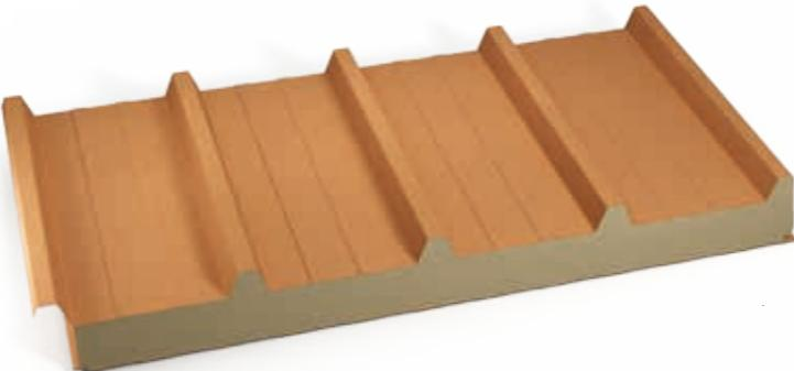
Il montaggio dei pannelli in parete può avvenire in posa sia verticale sia orizzontale. Nel caso di posa orizzontale si raccomanda di posizionare i pannelli con il maschio verso l'alto. Panels may be mounted as wall cladding, both vertically and horizontally. When mounting horizontally, it is recommended to install the panels with male facing up.
